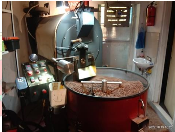
Gambar 2.4 Proses roasting kopi diruang produksi anoa coffee
