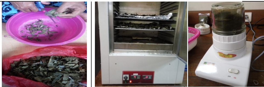
Proses pemotongan, pengeringan dengan oven dan penghalusan sampel daun A. muricata L.
