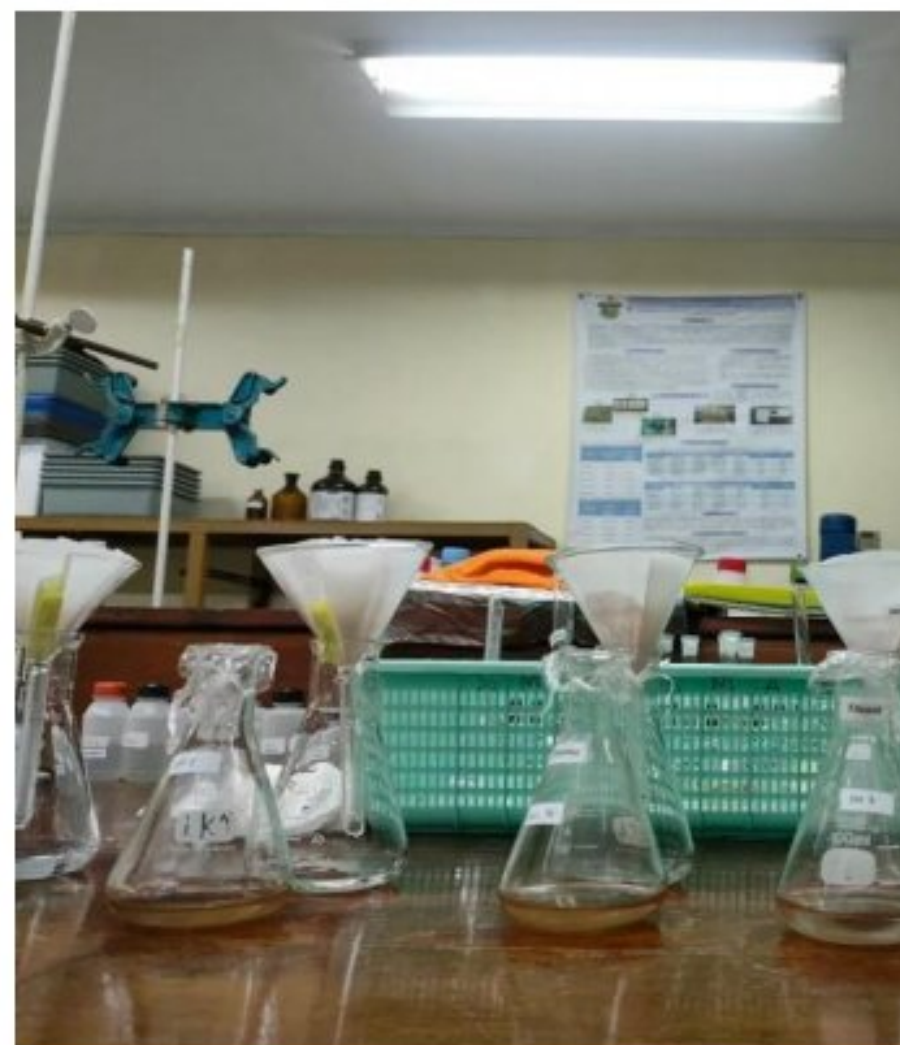
Gambar 30. Proses penyaringan adsorben dengan larutan
