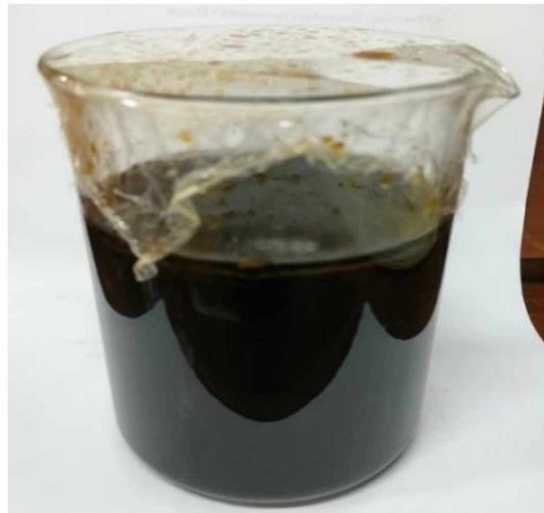
Gambar 25. Larutan \text{FeCl}_3 dengan penambahan \text{FeSO}_4 dan \text{NH}_4\text{OH}
