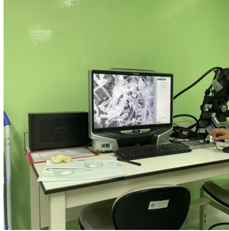
Uji selulosa dan selulosa asetat dengan mikroskop digital
