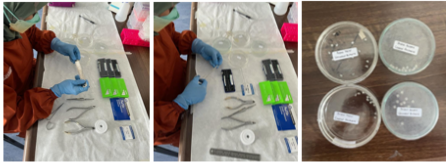
Gambar 13. a. Coated dan uncoated NiTi archwire dipotong masing-masing ukuran yang sama, b. Archwire dimasukkan ke slot braket sesuai dengan kelompok yang telah ditentukan, c. Setiap kelompok braket dan archwire diligasi dengan ligature wire dengan 3 ulir.
