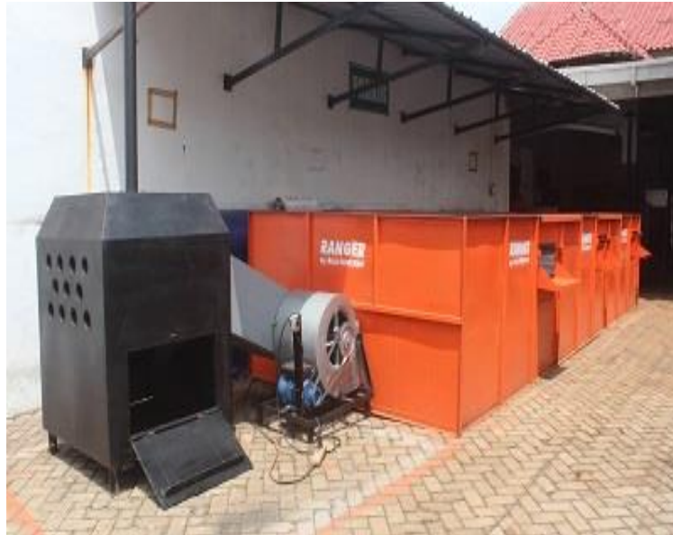
Gambar 3. Alat pengering jagung (Sumber : Suciyanto., 2011)
