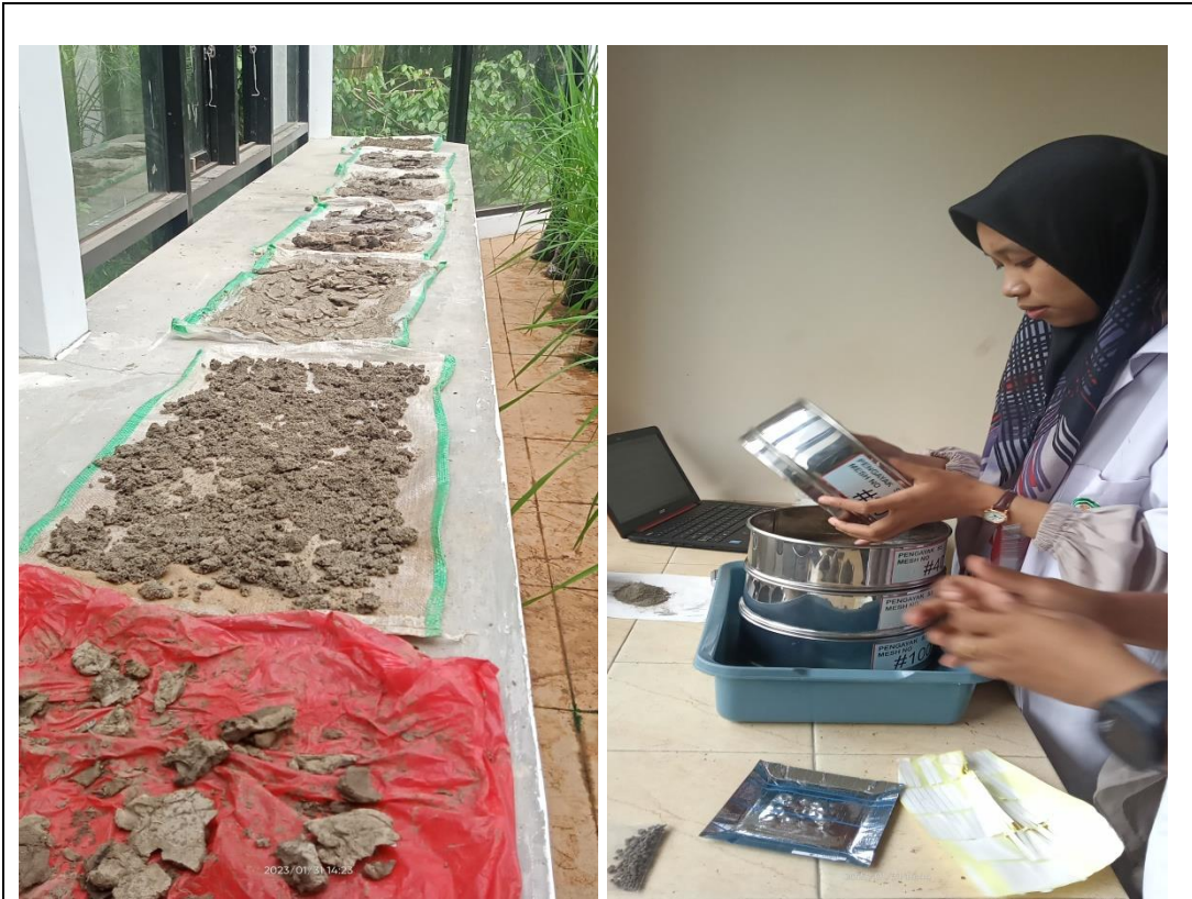
Deskripsi Singkat : Proses pengeringan dan pengayakan sampel sedimen
