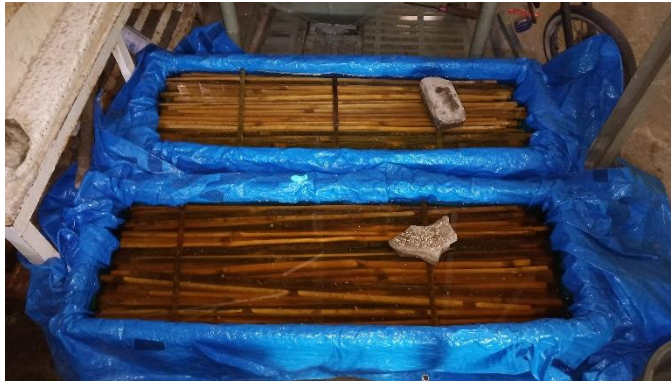
Gambar 4.5 Perendaman Bambu dengan Bahan Pengawet
