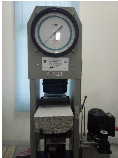
Gambar 6.27 Set-Up Alat Pengujian Kuat Lentur menggunakan Universal Testing Machine (UTM)
