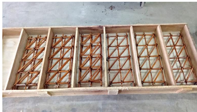
Gambar 4.13 Persiapan Pencetakan Pelat Uji Tulangan Bambu
