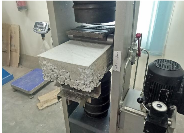
Gambar 4.17 Set-Up Alat Pengujian Kuat Lentur menggunakan Universal Testing Machine (UTM)
