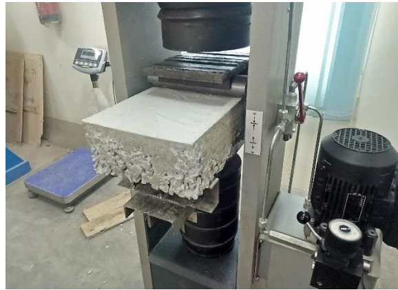
Gambar 6.27 Set-Up Alat Pengujian Kuat Lentur menggunakan Universal Testing Machine (UTM)
