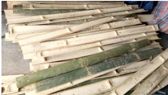
Gambar 6.6 Bambu Dibelah Menjadi Beberapa Bagian Sebelum Dijemur
