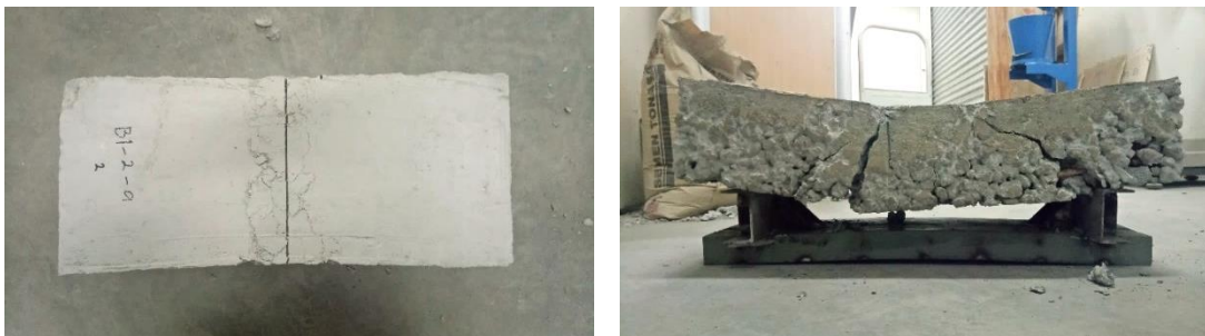
Gambar 6.30 Kondisi Pelat Setelah Pengujian
