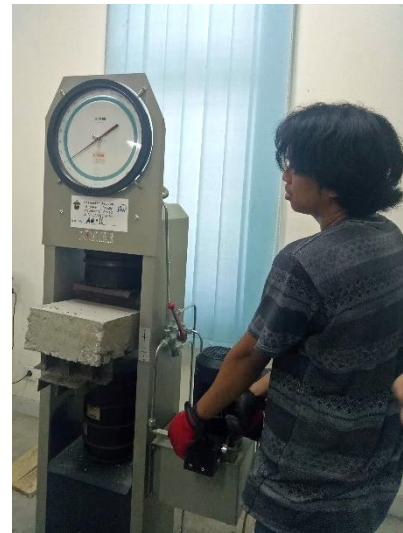
Gambar 6.27 Set-Up Alat Pengujian Kuat Lentur menggunakan Universal Testing Machine (UTM)
