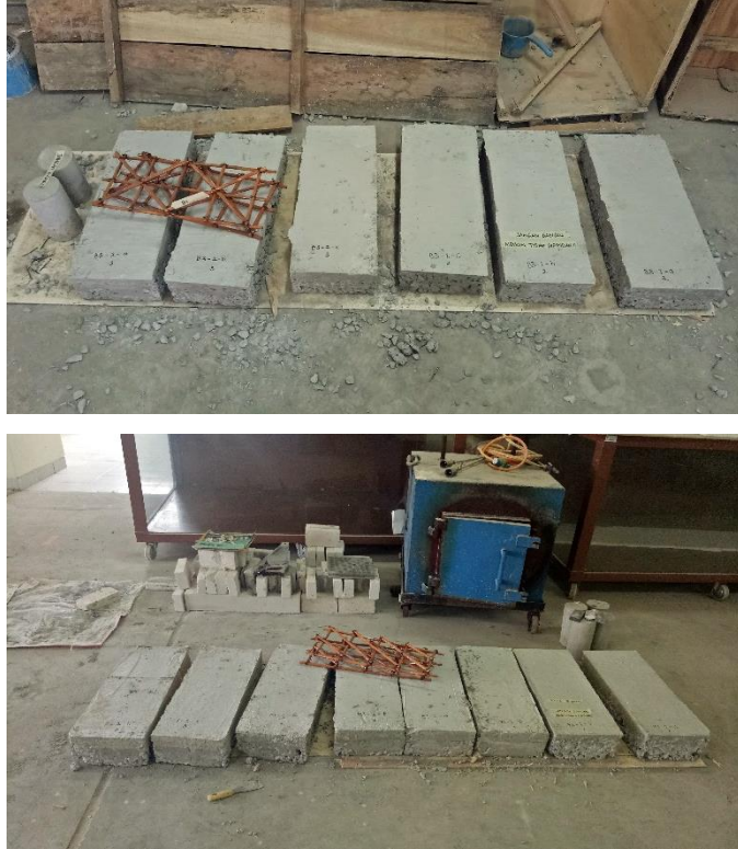
Gambar 6.23 Perawatan Dry Curing Pelat Uji Tulangan Bambu
