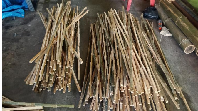
Gambar 6.8 Bambu Dibelah Menjadi Ukuran yang Lebih Kecil
