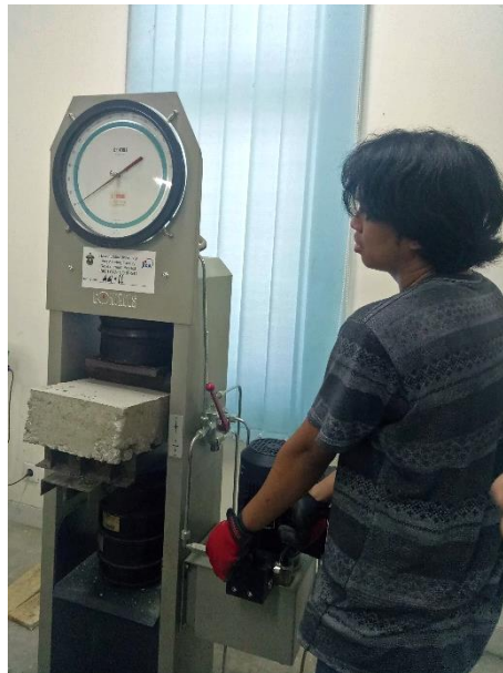
Gambar 4.18 Pengujian Kuat Lentur Pelat
