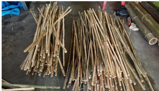
Gambar 4.3 Bambu Dibelah Menjadi Ukuran yang Lebih Kecil untuk Memudahkan Proses Penyerapan Larutan Pengawet.
