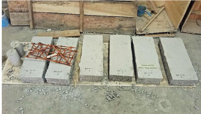
Gambar 4.15 Perawatan Dry Curing Pelat Uji Tulangan Bambu
