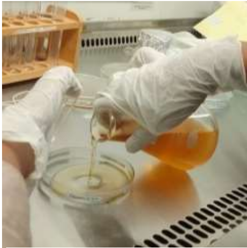
Gambar 9. Proses penuangan base layer
