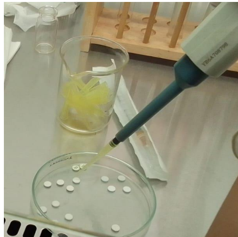
Gambar 13. Proses pemberian larutan uji ke paper disc
