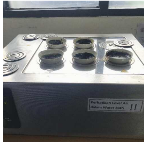
Gambar 13 dan 14. Penguapan Pelarut dengan Rotari Evaporator dan Waterbath
