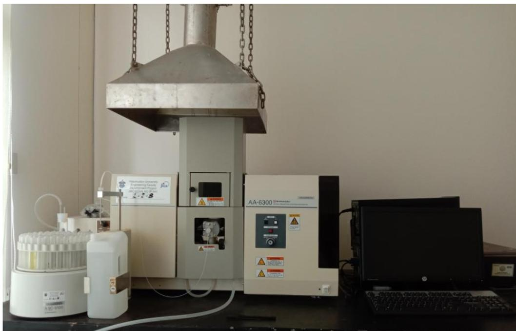
**Gambar 2.** Spektrofotometer Serapan Atom (SSA)
