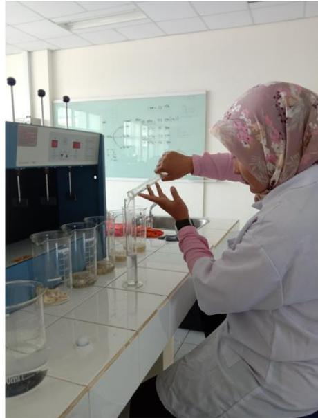
Pencampuran larutan logam cr dengan adsorben
