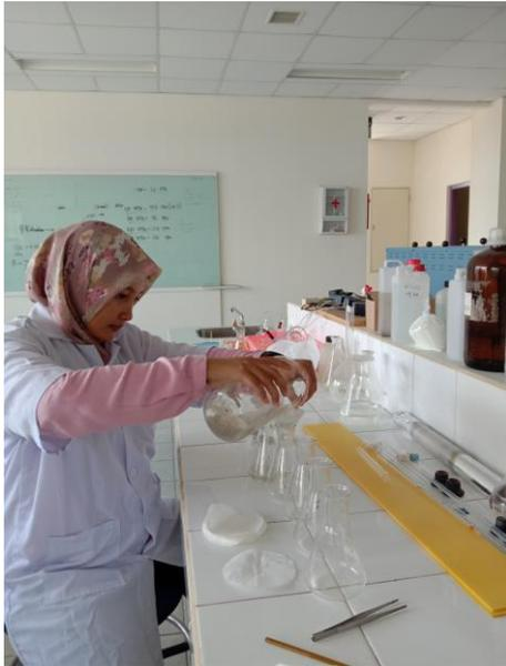
Penyaringan larutan logam Cr dari adsorben menggunakan kertas saring
