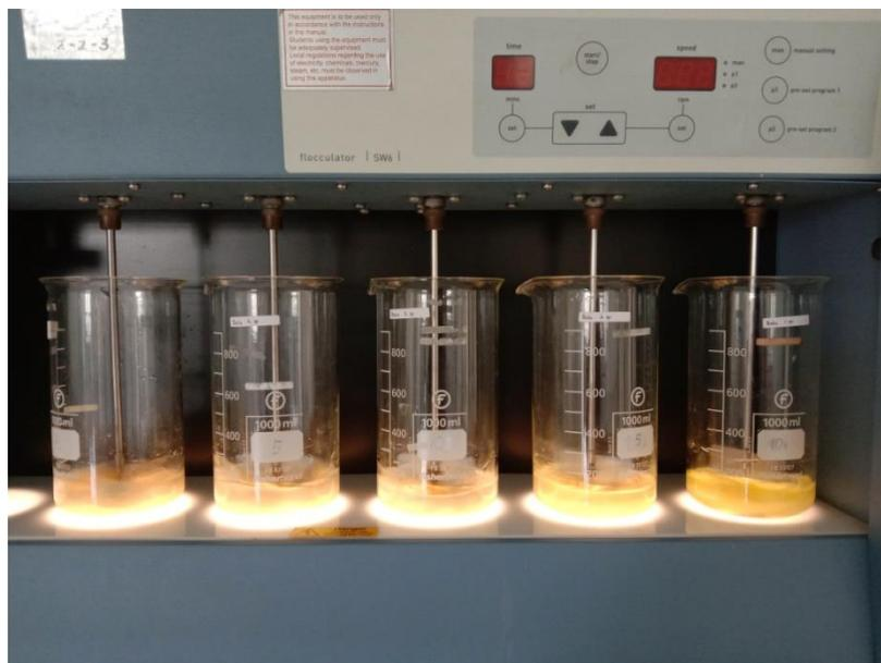
Pengadukan adsorben dengan larutan logam cr menggunakan *flocculator*
