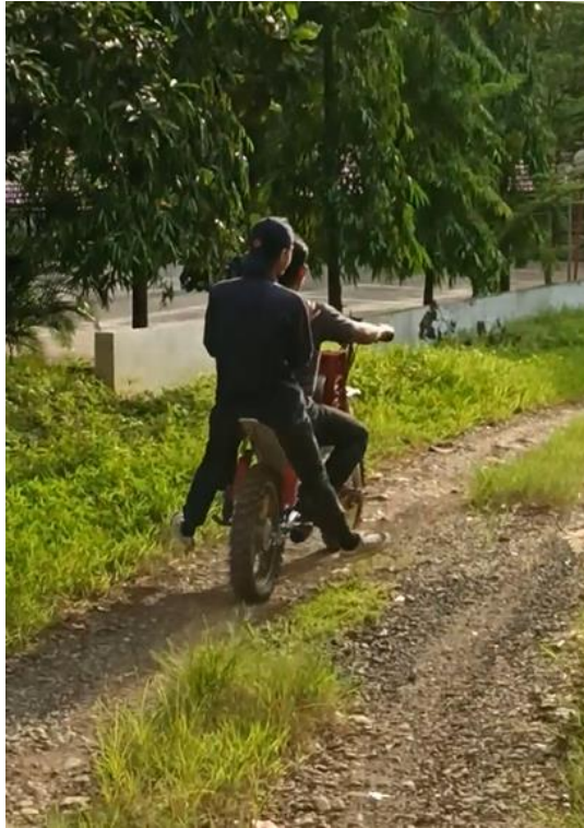
Gambar 53. Pengujian mobilitas pulper pada jalan berkerikil.
