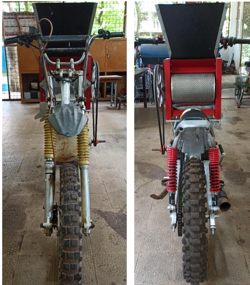
Gambar 56. Mesin pengupas kopi ( pulper ) mobile tampak depan dan belakang.
