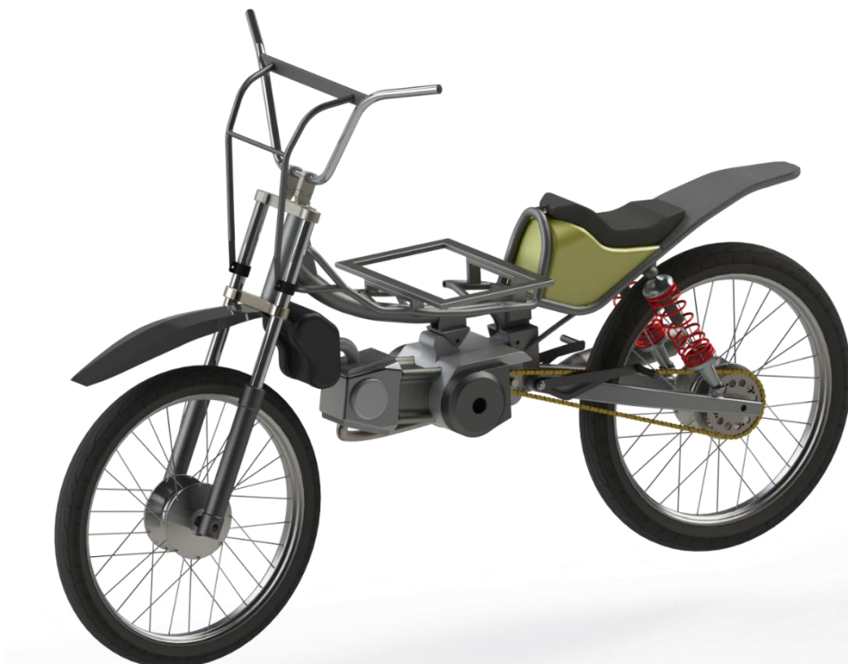
Gambar 36. Hasil rendering unit penggerak pulper mobile .
