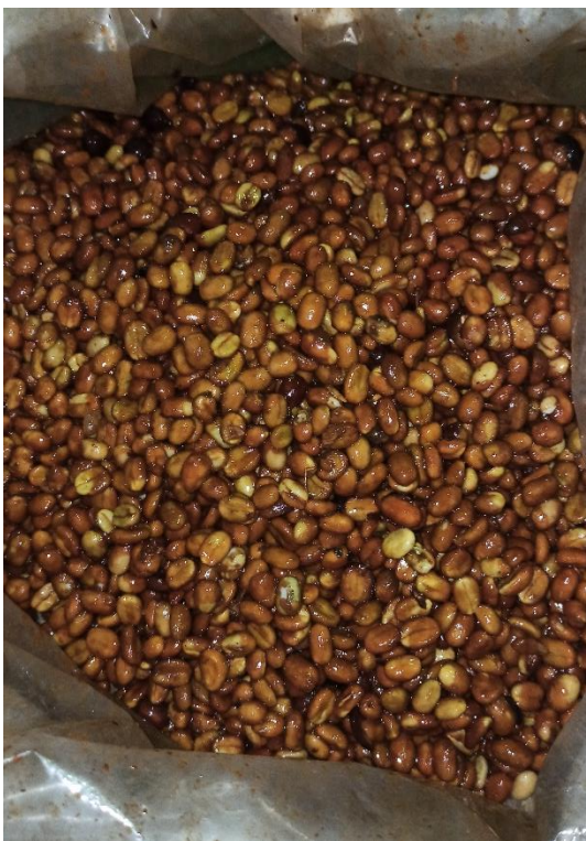
Gambar 51. Biji kopi hasil pengujian pengupasan.
