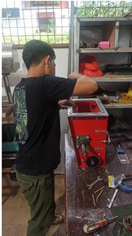
Gambar 41. Penyesuaian rangka dengan unit pengupas.
