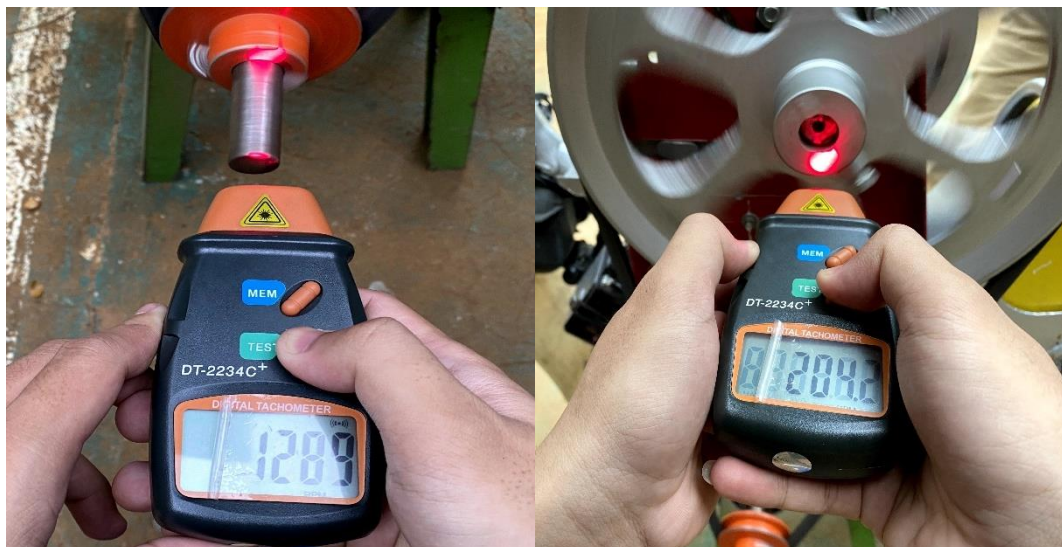
Gambar 50. Pengukuran kecepatan putaran poros dengan tachometer .
