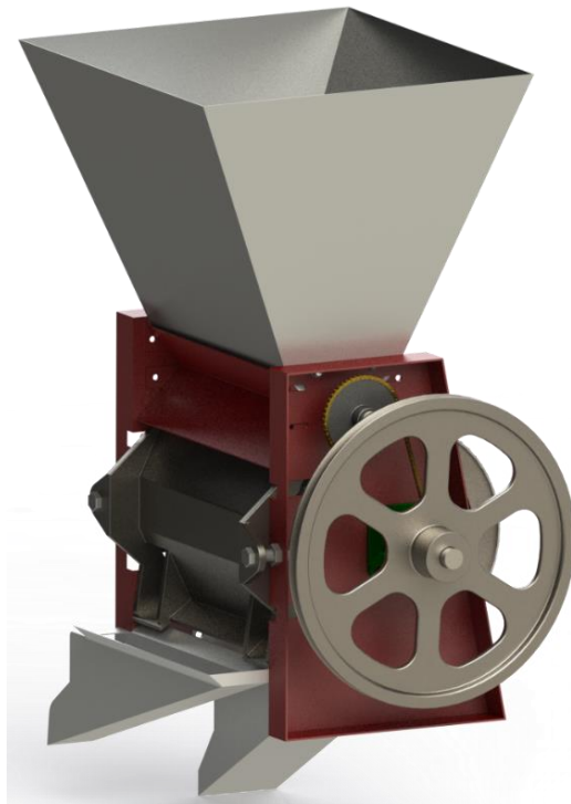
Gambar 37. Hasil rendering unit pengupas.
