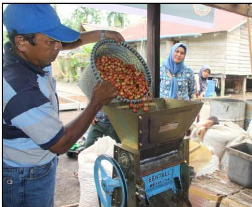
Gambar 7. Pengupasan kopi metode *pulping* (Sumber: Nasution dkk., 2018).
