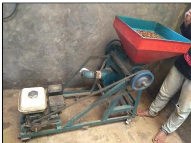
Gambar 11. Pengupasan kulit tanduk (*Hulling*) (Sumber: Hendrawan, 2019).
