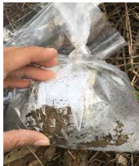
(d) Memasukkan tanah ke plastik sampel
