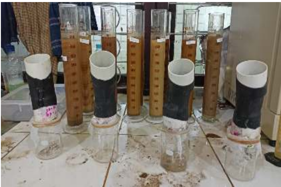
(d) Uji permeabilitas tanah
