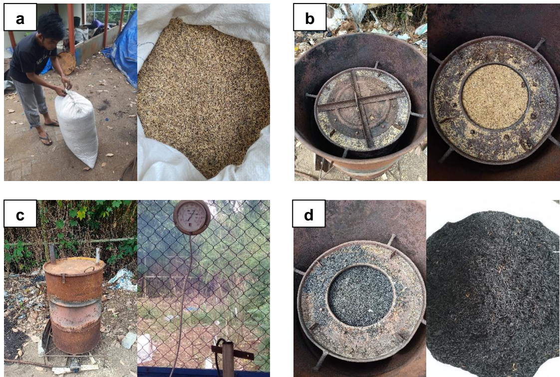
Gambar Lampiran 3. Proses pembuatan biochar sekam padi: (a) penyiapan bahan sekam padi, (b) Memasukkan sekam padi dalam tungku pembakaran, (c) Pembakaran secara pirolisis pada suhu 300°C, (d) Biochar sekam padi yang sudah jadi.
