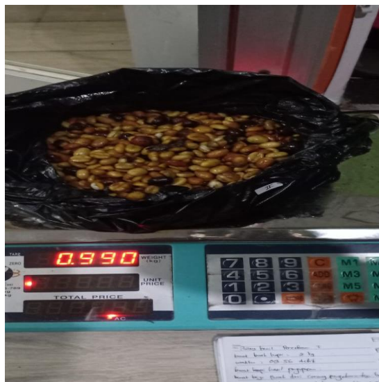
Gambar 17. Biji Hasil Pengupasan Menggunakan Pulley 17 cm.
