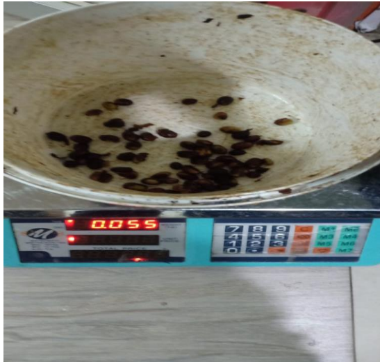
Gambar 19. Biji Kopi Tidak Terkupas Menggunakan Pulley 17 cm.
