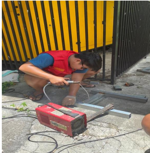
Gambar 13. Proses pengelasanudukan mesin pulper
