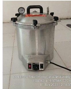
Gambar 8. Beras disterilisasi menggunakan Autoklaf
