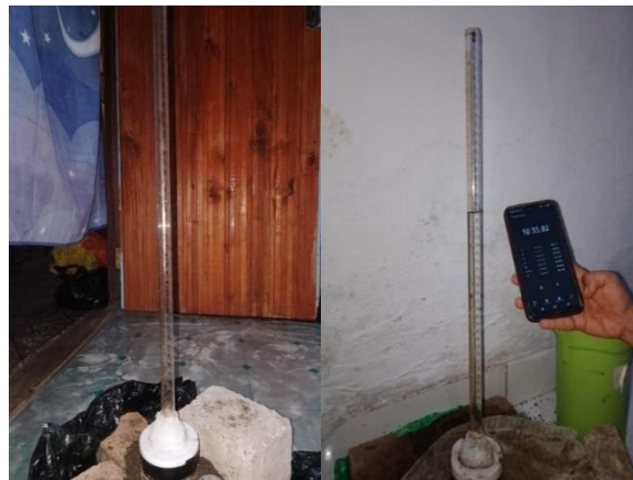
Gambar 16. Dokumentasi pengukuran konduktivitas hidrolis tanah.
