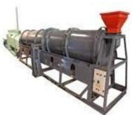
Gambar 2.8 : Mesin Pengering Pakan Ayam *Rotary Dryer*
