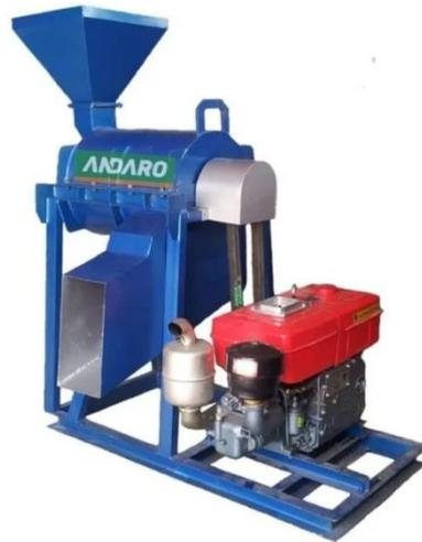
Gambar 2.5 : Mesin Hammer Mill
