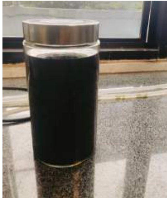
Gambar 3. Diamkan 3x24 jam, larutan telah berubah warna menjadi hijau pekat disaring dan larutan ekstrak telah siap untuk dievaporasi
