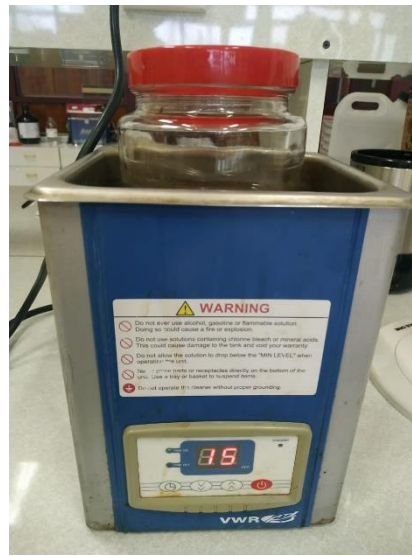
ekstraksi dengan heksan, menggunakan sonikator
