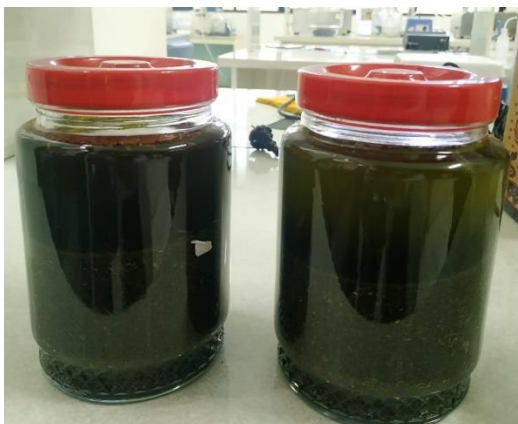
Ekstraksi dengan etanol 50% secara maserasi
