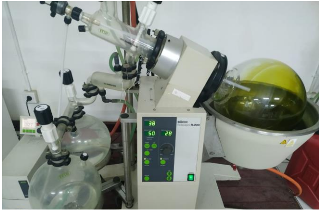
Proses penguapan pelarut etanol dengan rotavapour
