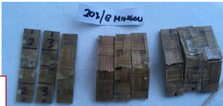
Hasil Patahan Uji Bending
