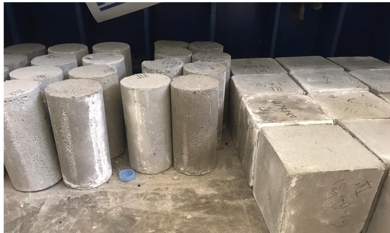
Gambar 9. Proses curing udara benda uji
