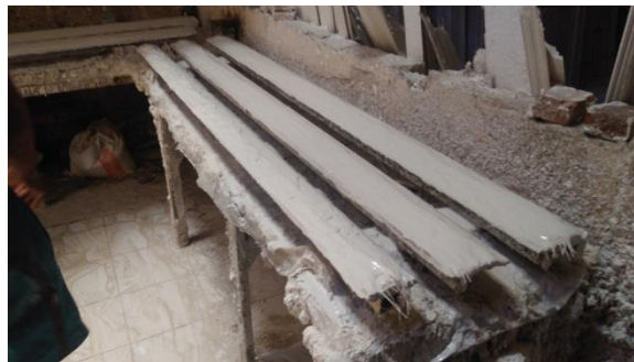
Gambar 26. Ornamen Gypsum Yang Sudah Selesai Di Cetak
