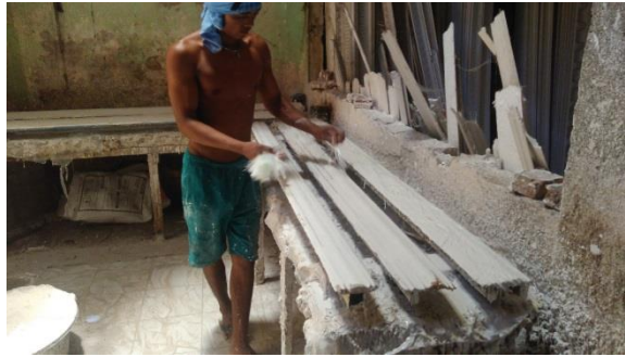
Gambar 24. Pemberian Roving Atau Serat
