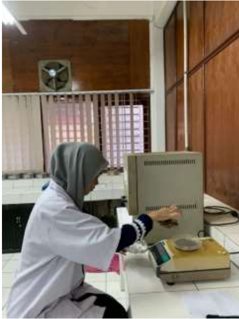
Menimbang sampel kering lamun yang telah dioven untuk pengukuran biomassa
