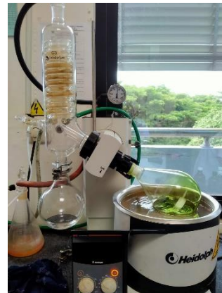
Gambar 21. Penguapan Ekstrak Cair menggunakan Rotary Evaporator
