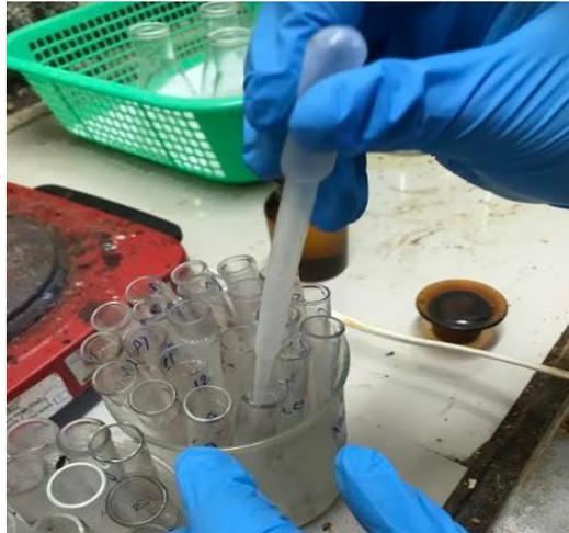
c. Pemasukan larutan ke dalam botol alat *Atomic Absorption Spectrophotometer*
