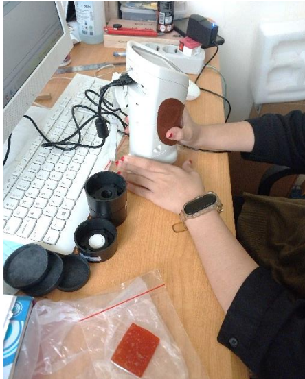
Pengujian warna menggunakan colorimeter
