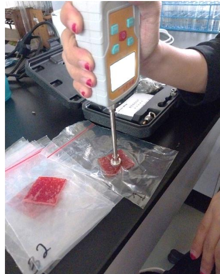
Pengujian tesktur menggunakan penetrometer
