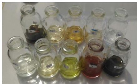
Gambar 13 : Fraksi (F1-10) hasil kromatografi kolom konvensional
