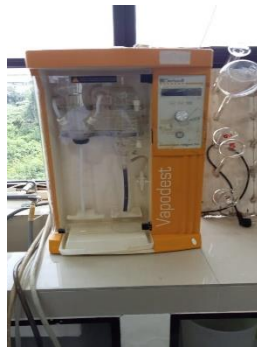
Destilationssystem Vapodest 30s
