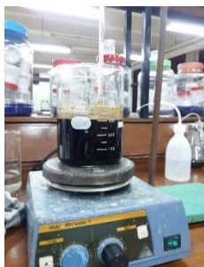
Proses delignifikasi menggunakan NaOH 8%
