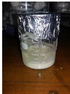
Perendaman dengan etanol 99% selama 24 jam
