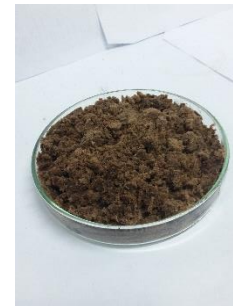
Sampel kulit durian setelah di soxhlet
