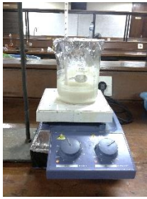
Proses bleaching menggunakan H_2O_2 5%
