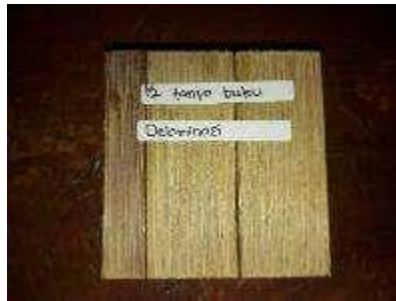
Sampel uji delaminasi
