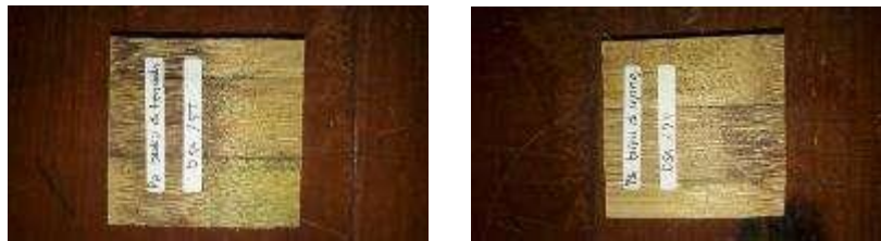
Sampel uji daya serap air dan pengembangan tebal
