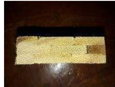
Sampel uji delaminasi
