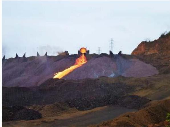
**Gambar 10.** Penuangan Terak Cair pada *Slag Dump*
