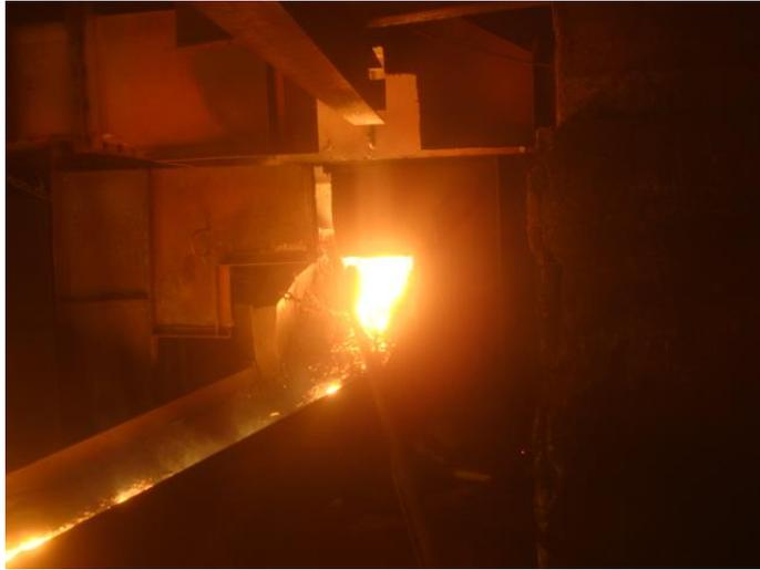
**Gambar 8.** Penyaringan Terak dari Tungku Listrik
