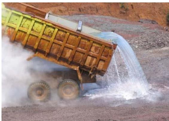
**Gambar 11.** Pendinginan Terak di *Slag Dump*
