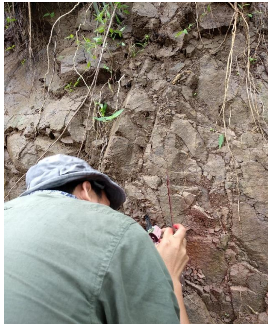
Gambar 3.3: Pengukuran kekar di lapangan
