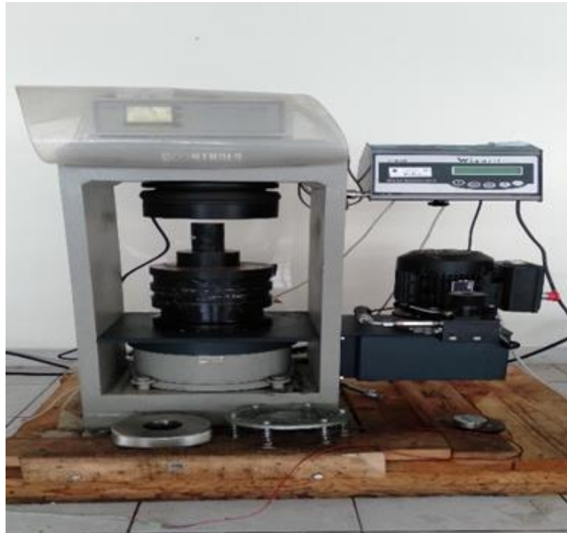
Gambar 3.6: Uniaxial compressive strength di Laboratorium Geologi Teknik.
