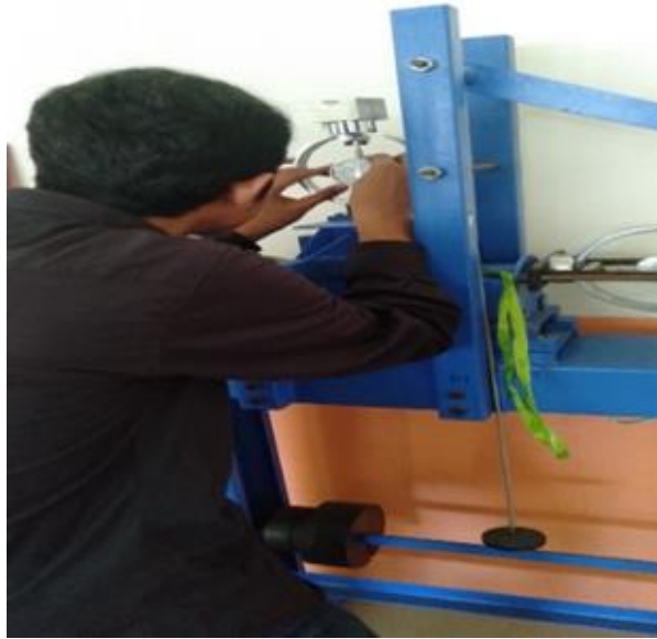
Gambar 3.5: Direct shear batuan di Laboratorium Geomekanika Teknik Pertambangan Universitas Muslim Indonesia
