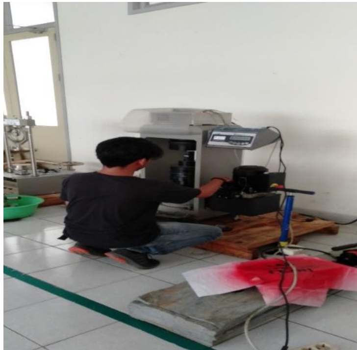
Gambar 4.5: Pengujian UCS di Laboratorium Geologi Teknik Jurusan Teknik Geologi Universitas Hasanuddin
