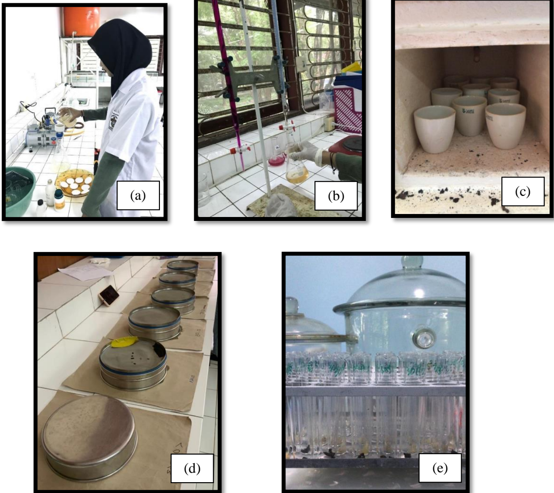
Gambar 7. Pengukuran Data di Laboratorium (a) Pengukuran TSS, (b) Pengukuran BOT Air, (c) Pengukuran BOT Sedimen, (d) Pengukuran Ukuran Butir Sedimen, (e) Pengukuran Logam di BBLK
