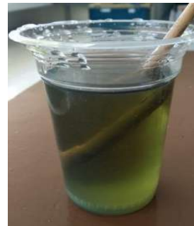
Pencampuran Resin Epoxy dan Hardener dengan perbandingan 60/40 %.
