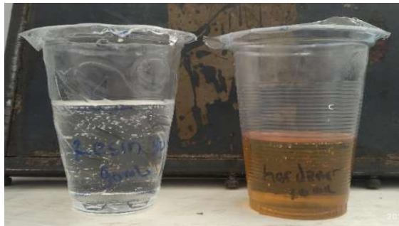
Pencampuran Resin Epoxy dan Hardener dengan perbandingan 60/40 %.
