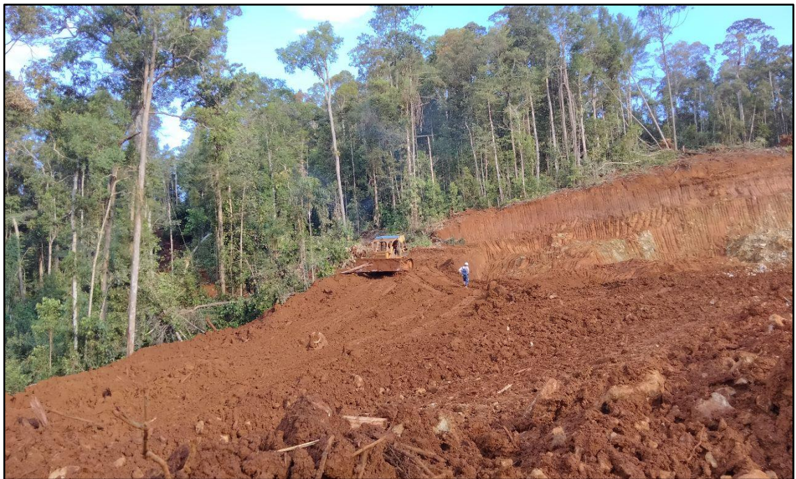
Gambar 2. Kegiatan pengupasan overburden di blok C (daerah tangkapan hujan 3)
