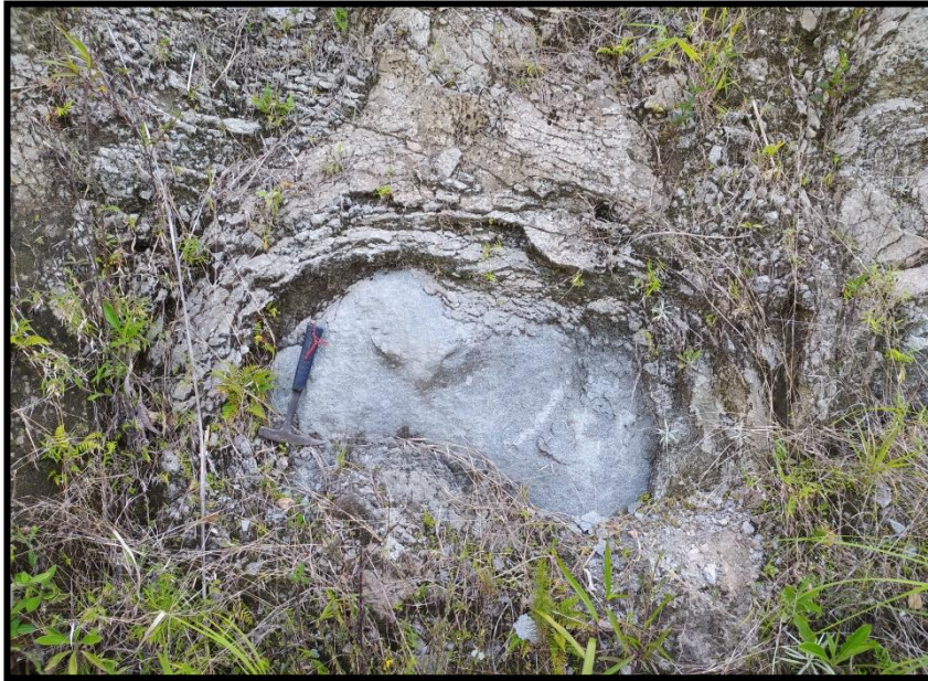
Gambar 2. 11 Pelapukan kimia spheroidal weathering pada litologi basalt di stasiun 17 difoto relatif arah N 30° E
