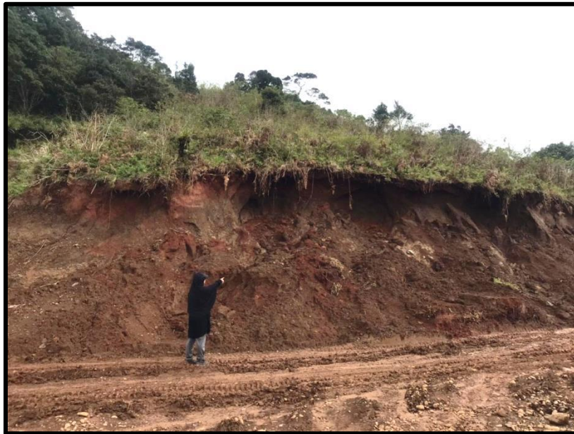
Gambar 2. 16 Residual soil yang terbentuk dari hasil pelapukan batuan yang ada di bawahnya dengan ketebalan \pm 3,5 meter N 229° E
