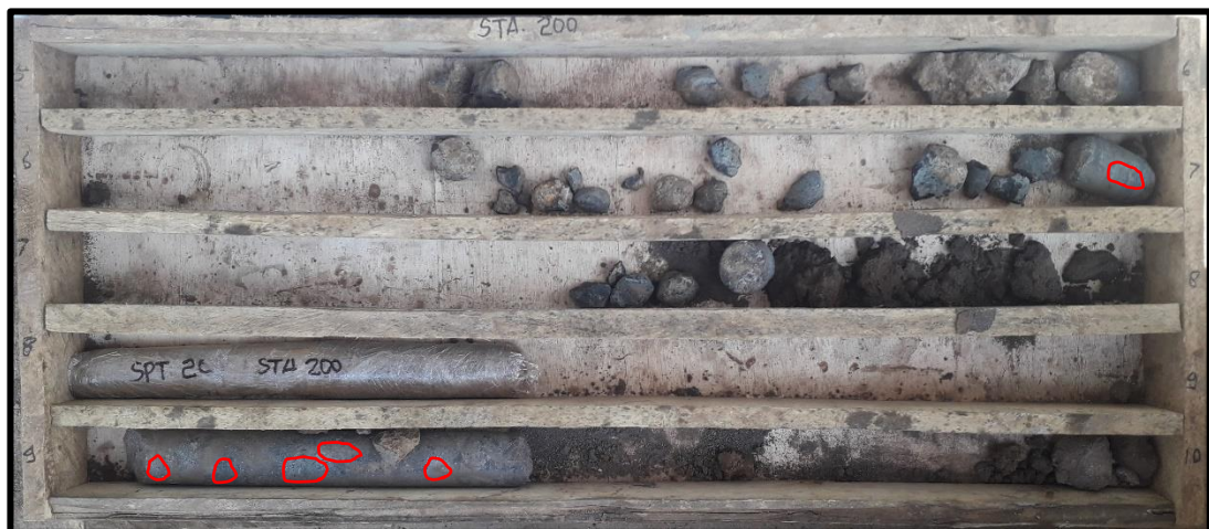
Gambar 4.3 Singkapan breksi bawah permukaan pada STA 0+200 (BW 14) Spillway , terlihat kenampakan fragmen batuan yaitu basalt.
