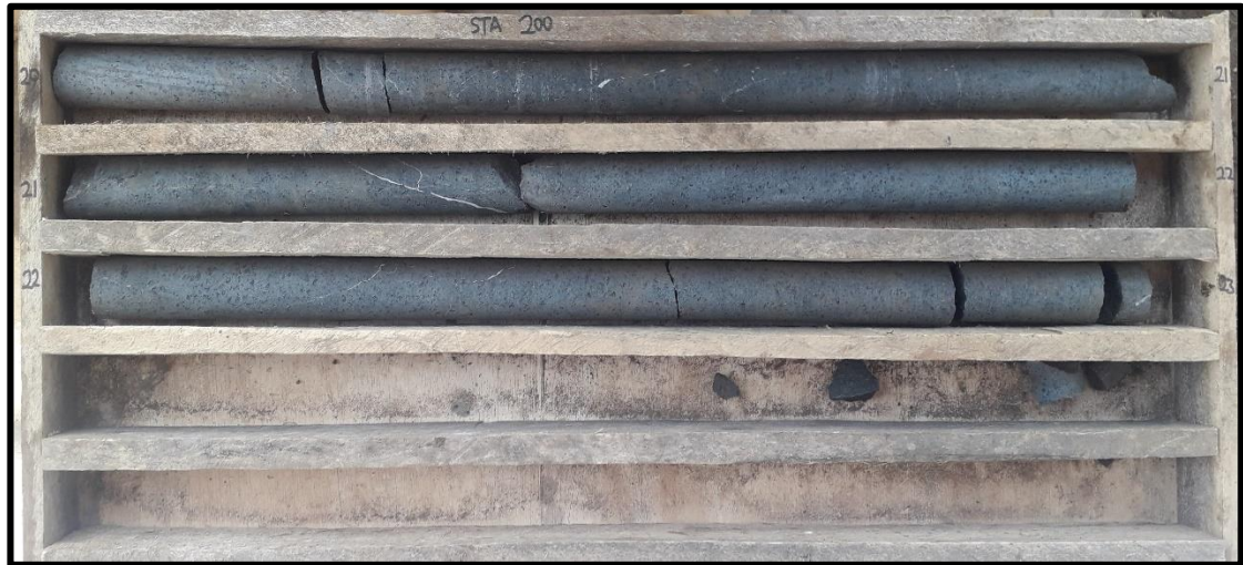
Gambar 4.2 Singkapan basalt bawah permukaan pada STA 0+200 (BW 14) Spillway .
