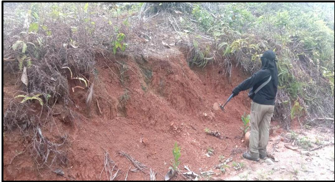
**Gambar 2.15** Kenampakan erosi *rill* dengan tebal soil 1 meter di foto pada stasiun 20 dengan arah foto N 315° E
