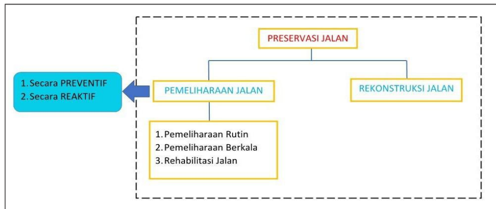
Gambar 2. Lingkup Prevervasi Jalan
