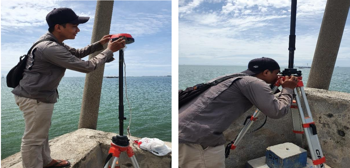
Gambar 1. Pembuatan titik BM dan pengamatan geodetik
