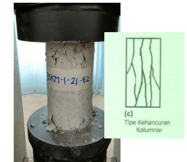
Beton BSKM-1-21-E2 Pola Retak Kolumnar
