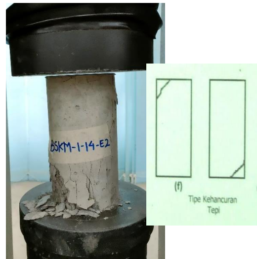
Beton BSKM-1-14-E2 Pola Retak Tepi
