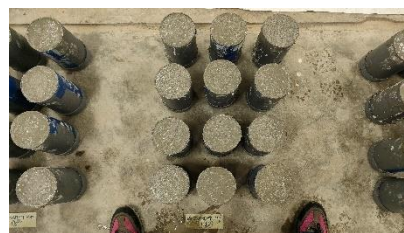
Mendiamkan campuran beton + Sikament-NN 1,5% selama 48 jam
