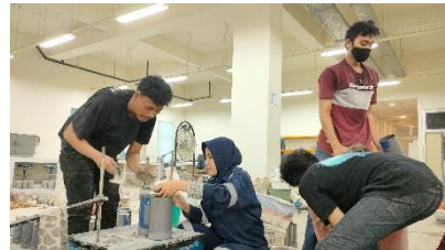
Proses meratakan material dalam benda uji di mesin vibrator
