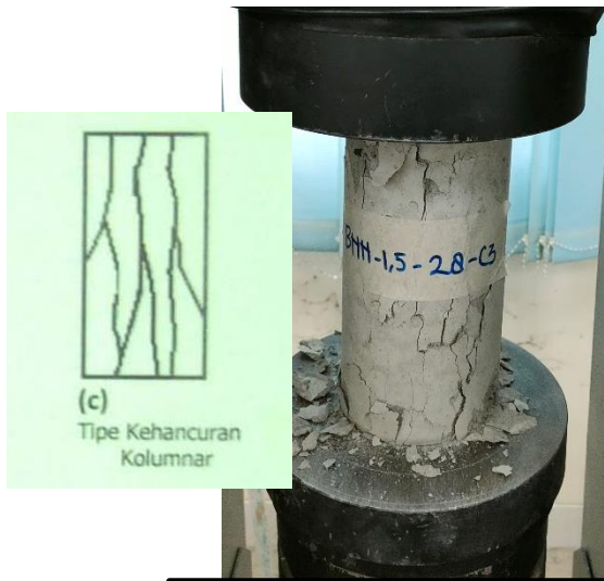
Beton BNN-1,5-28-C3 Pola Retak Kolumnar
