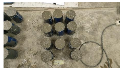
Mendiamkan campuran beton + Sikament-NN 2% selama 48 jam
