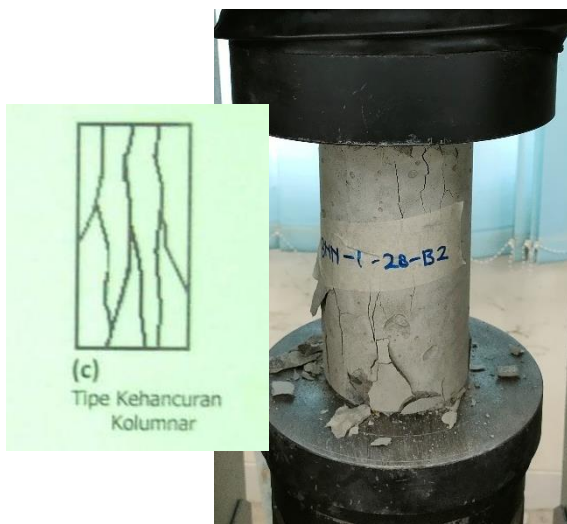
Beton BNN-1-28-B2 Pola Retak Kolumnar
