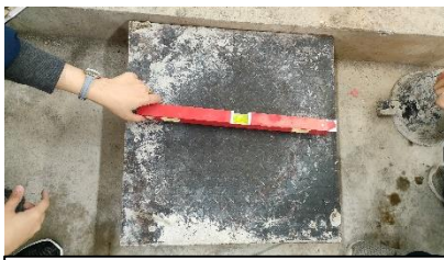
Membersihkan alas pengujian slump
