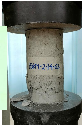
Beton BSKM-2-14-G3 Pola Retak Kolumnar
