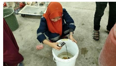
Pencampuran Sikament-NN variasi 1,5% kedalam air
