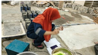
Proses menghitung setting time beton dengan campuran sikament-NN 1,5%
