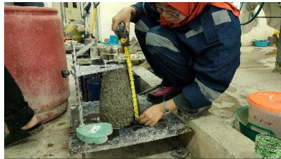
Mengukur tinggi slump campuran Sikament-NN 1%
