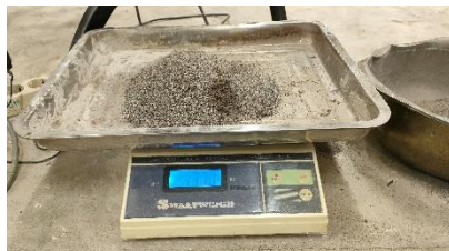
Penimbangan agregat halus untuk dimasukkan kedalam oven
