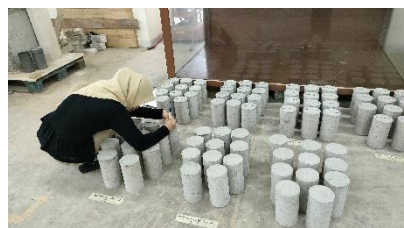
Mengukur dan menimbang sampel untuk pengujian hari ke 14
