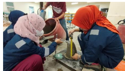
Mengukur tinggi slump campuran Sikament-NN 1,5%
