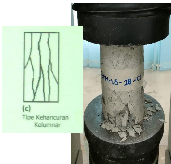
Beton BNN-1,5-28-C1 Pola Retak Kolumnar
