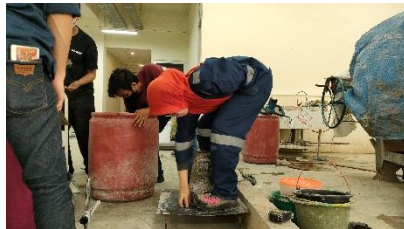
Memasukkan material kedalam kerucut abrasi
