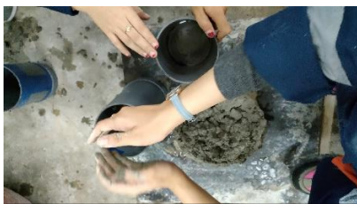
memasukkan campuran Sikacim Concrete Additive 1% ke cetakan
