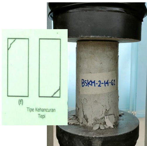
Beton BSKM-2-14-G1 Pola Retak Tepi
