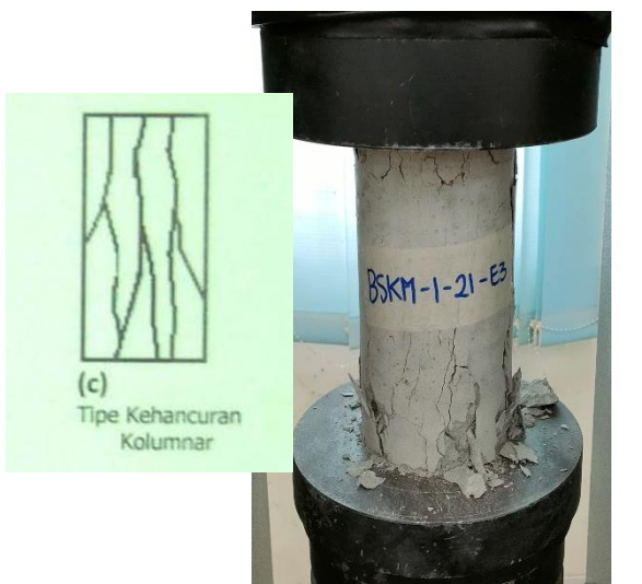
Beton BSKM-1-21-E3 Pola Retak Kolumnar
