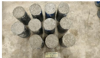
Mendiamkan campuran beton normal selama 48 jam
