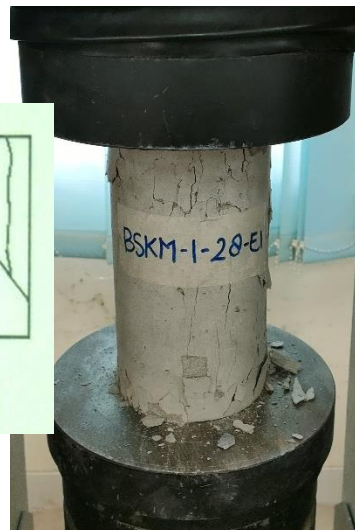
Beton BSKM-1-28-E1 Pola Retak Kerucut dan Belah
