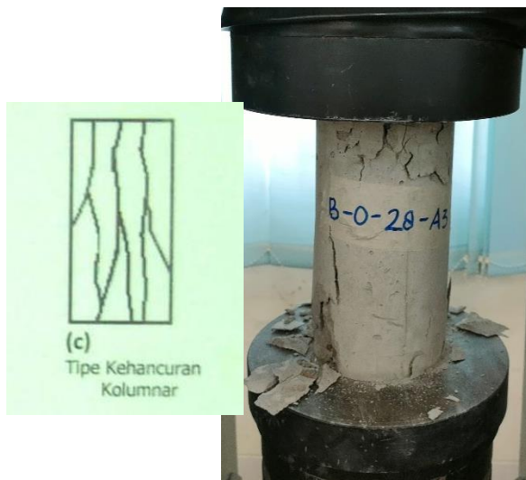
Beton B-0-28-A3 Pola Retak Kolumnar
