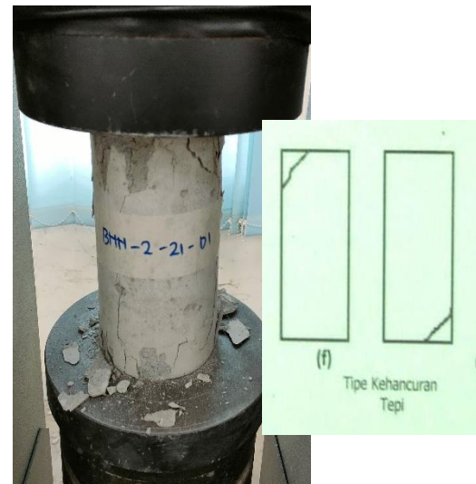
Beton BNN-2-21-D1 Pola Retak Tepi
