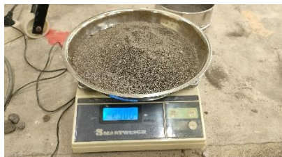
Penimbangan agregat halus untuk pengujian analisis saringan
