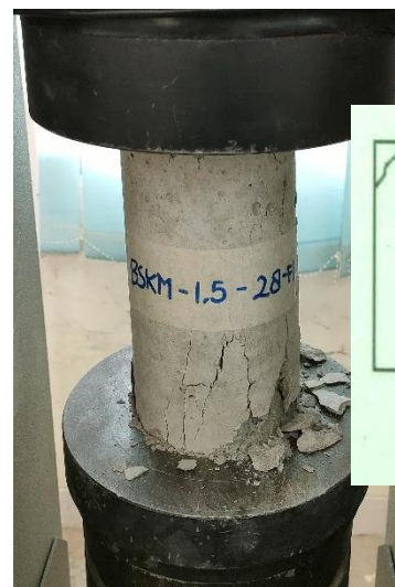
Beton BSKM-1,5-28-F1 Pola Retak Tepi
