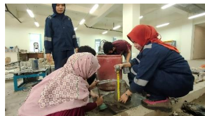
Mengukur tinggi slump campuran Sikament-NN 2%
