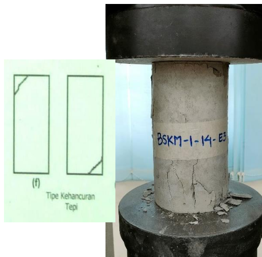
Beton BSKM-1-14-E3 Pola Retak Tepi
