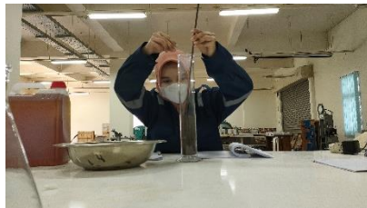
Proses memasukkan agregat halus (pasir) kedalam gelas ukur
