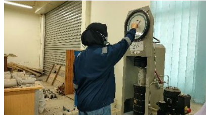
Uji kuat tekan beton hari ke 28
