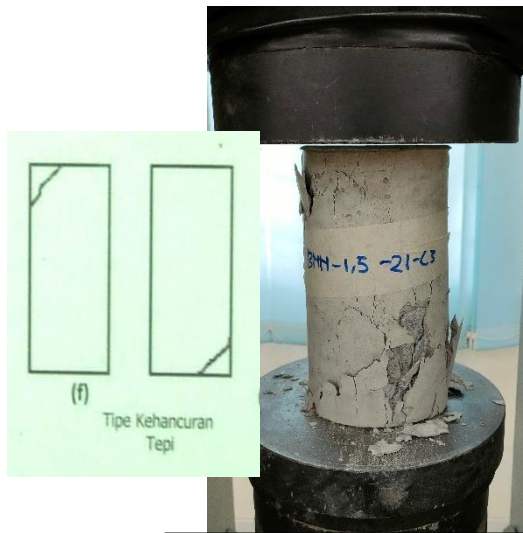
Beton BNN-1,5-21-C3 Pola Retak Tepi
