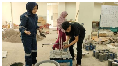
Proses pemindahan benda uji dari vibrator ke tempat perawatan beton
