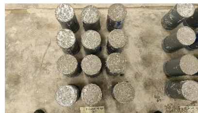
Mendiamkan campuran beton + Sikament-NN 1% selama 48 jam
