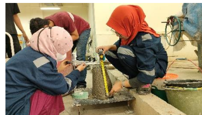
Mengukur tinggi slump beton normal
