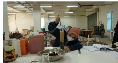
Proses memadatkan agregat halus yang telah diberi air
