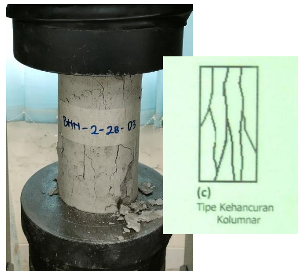
Beton BNN-2-28-D3 Pola Retak Kolumnar
