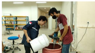
Memasukkan (air + Sikament-NN 2%) kedalam campuran beton
