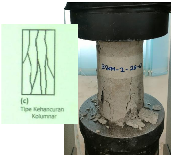
Beton BSKM-2-28-G1 Pola Retak Kolumnar
