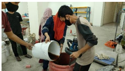
Memasukkan (air + Sikament-NN 1,5%) kedalam campuran beton
