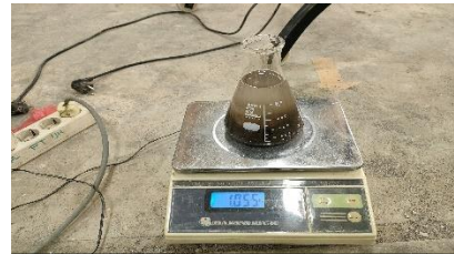
Penimbangan agregat halus + Erlenmeyer +Air
