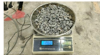
Penimbangan agregat kasar untuk dimasukkan kedalam oven
