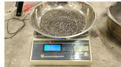
Penimbangan agregat halus setelah dikeluarkan dari oven
