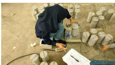
Mengukur dan menimbang sampel untuk pengujian hari ke 21
