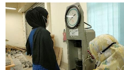
Uji kuat tekan beton hari ke 14
