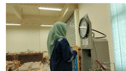
Uji kuat tekan beton hari ke 21
