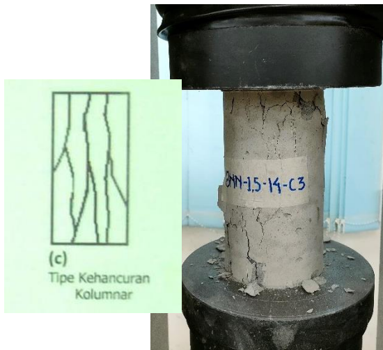
Beton BNN-1,5-14-C3 Pola Retak Kolumnar
