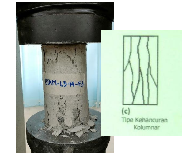
Beton BSKM-1,5-14-F3 Pola Retak Kolumnar
