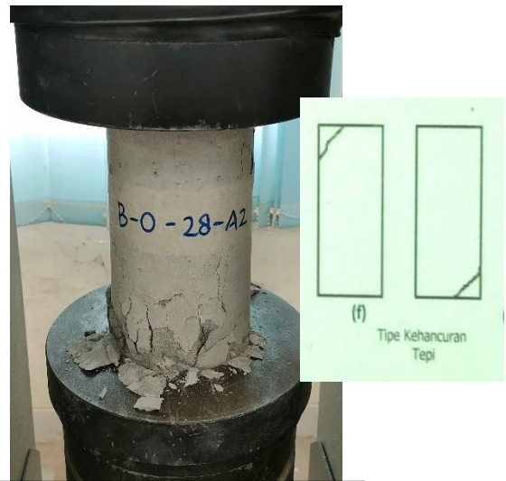
Beton B-0-28-A2 Pola Retak Tepi
