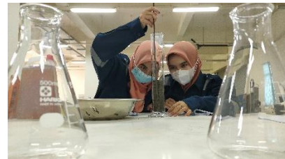
Proses memadatkan agregat halus (pasir) kedalam gelas ukur
