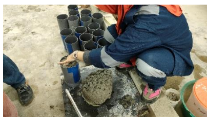
memasukkan campuran Sikacim Concrete Additive 2% ke cetakan
