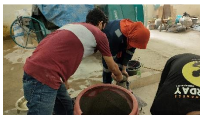
Memasukkan campuran beton kedalam kerucut abrasi
