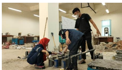
Memasukkan campuran beton kedalam cetakan
