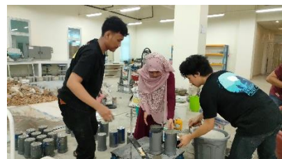
Proses meratakan material dalam benda uji di mesin vibrator
