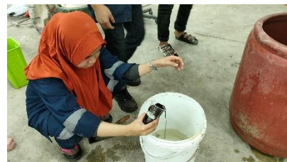
Pencampuran Sikament-NN variasi 2% kedalam air
