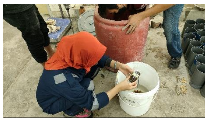
Pencampuran Sikament-NN variasi 1% kedalam air
