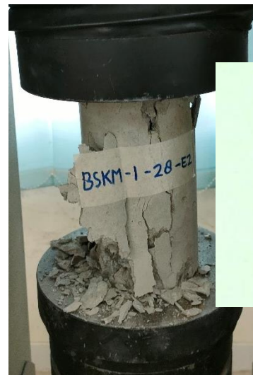
Beton BSKM-1-28-E2 Pola Retak Kolumnar
