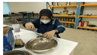
Proses memasukkan agregat halus (Pasir) kedalam Erlenmeyer
