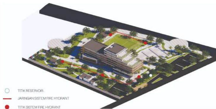
Gambar 11. Isometri sistem pencegahan kebakaran dalam bangunan
