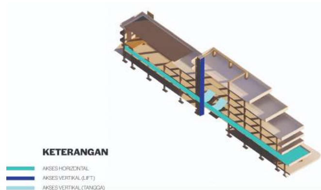
Gambar 8. Isometri sistem sirkulasi dalam bangunan
