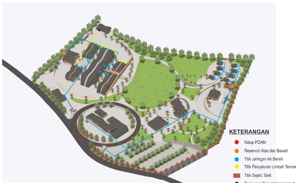
Gambar 2. 13 Sistem Air Bersih dan Kotor
