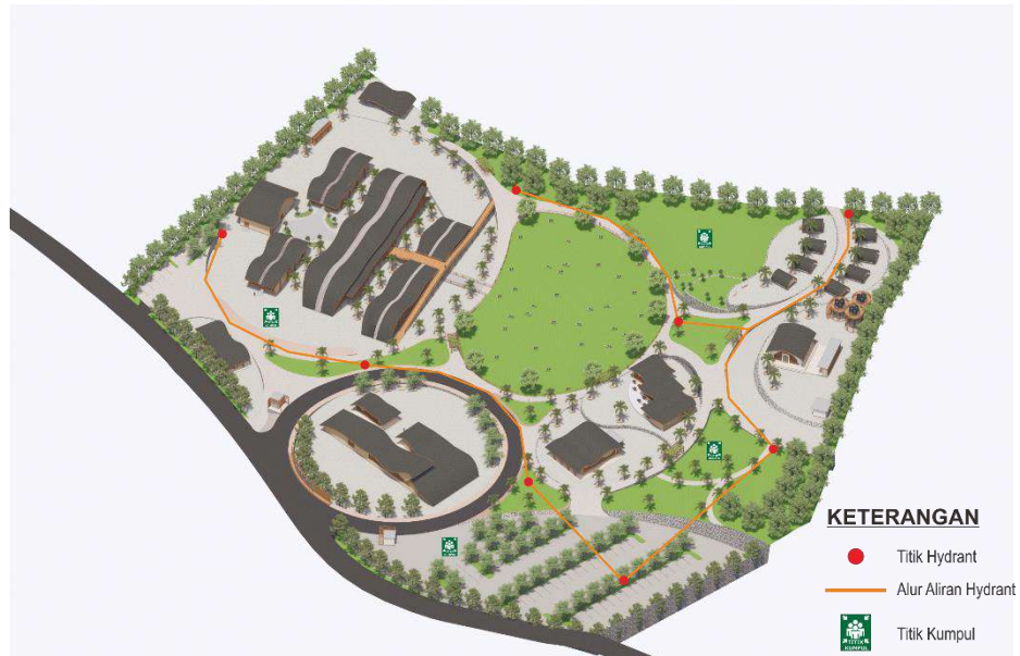
Gambar 2. 14 Sistem Pencegahan Kebakaran
