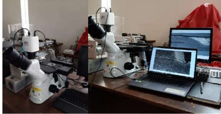
Gambar 11. Proses observasi struktur makro dan struktur mikro dengan mikroskop Euromax Oxion Inverso
