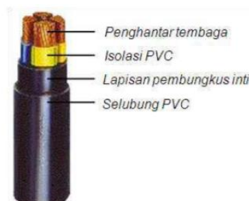
Gambar 4 Konstruksi Kabel Tanah (NYY) [11]
