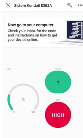
Gambar 15 Tampilan template blynk IoT pada *smartphone*
